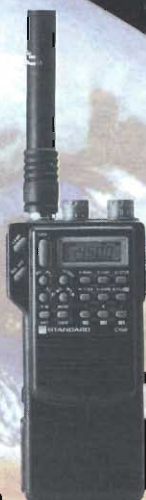
C-150 RICETRASMETTITORE VHF - 20 MEMORIE
