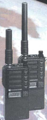
C-112 RICETRASMETTITORE VHF - 5W
